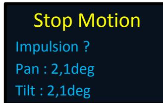
Vous pouvez régler la valeur de chaque impulsion à l'aide des deux potentiomètres (pan et tilt), par incrément de 0,1 degré.
